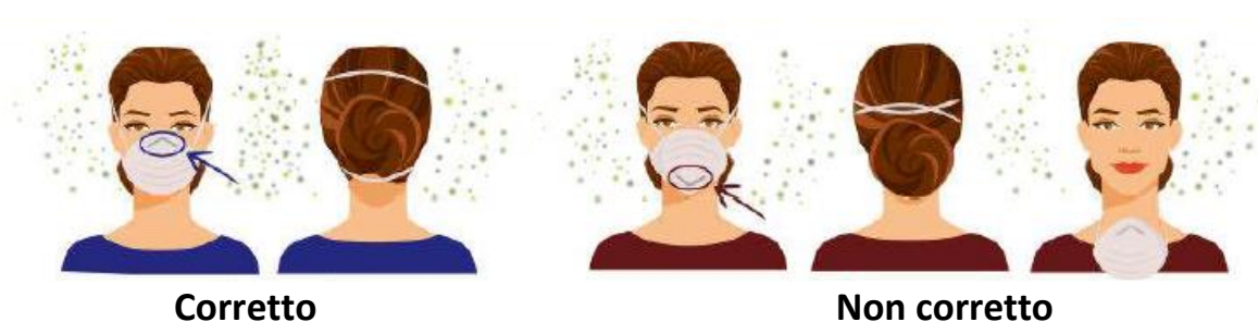
Figura 1: INDOSSARE CORRETTAMENTE IL FILTRANTE FACCIALE
